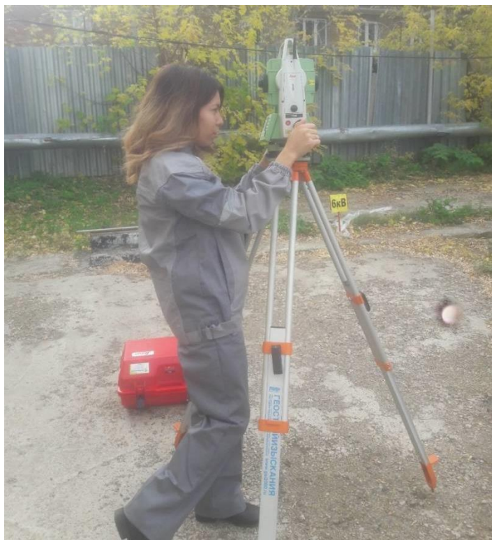
Фото.2.1 Тахеометрическая съемка производственного здания КНС-116
