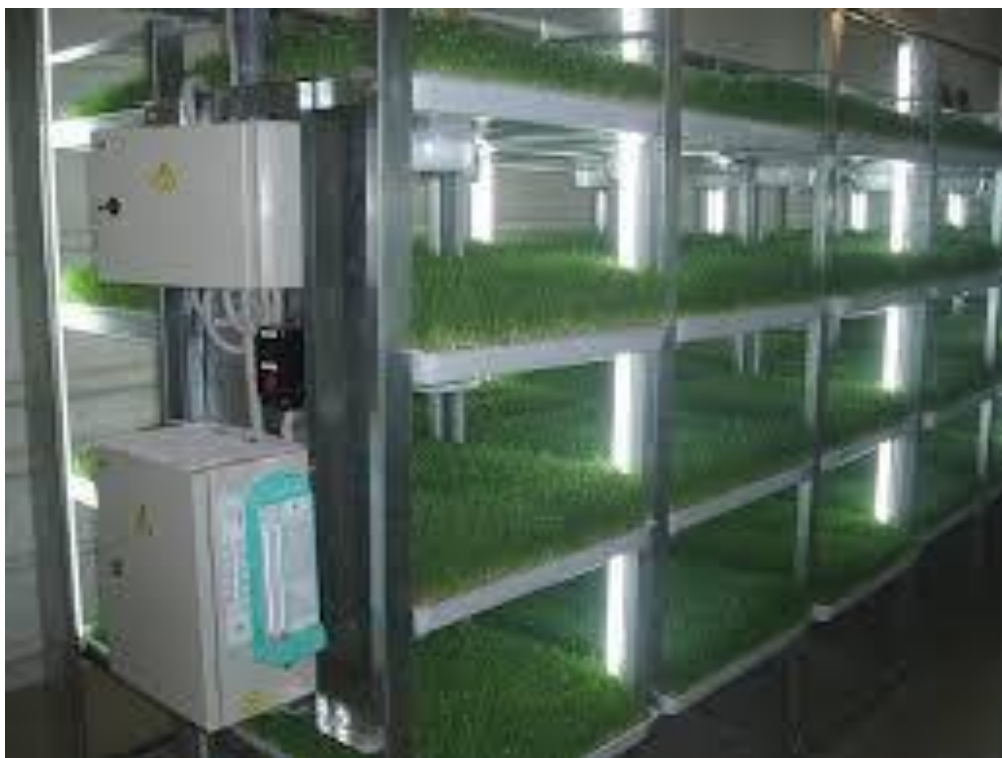
Рисунок 4. Гидропонная установка компании ООО «Агротехсервис»
