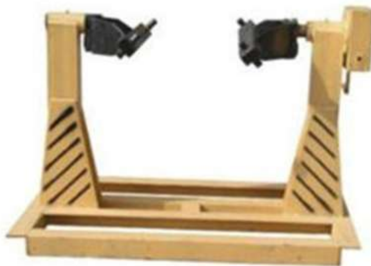
Рисунок 3.2 – Стенд для сборки-разборки двигателей Р-776-01У
