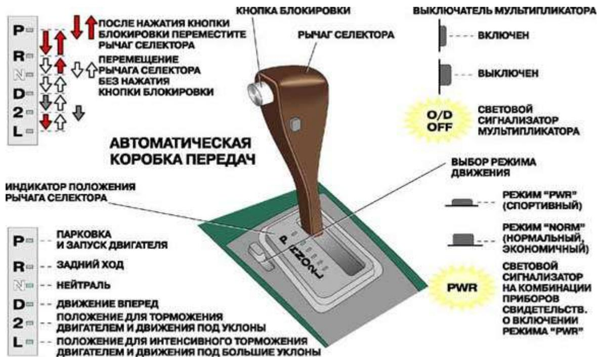
Рисунок 1.3 Положения селектора переключения
