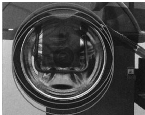
Рисунок 1.7 – Измерение радиальных биений колеса
