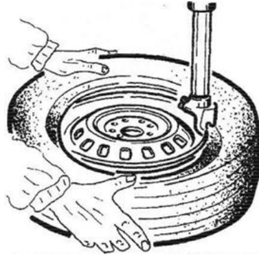
Рисунок 1.3 - Монтаж покрышки на обод колеса (забортовка)
