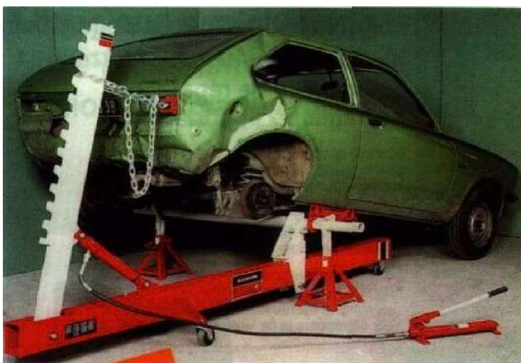
Рисунок 1.1 - Общий вид стенда Blackhawk Dozer AEK 90
