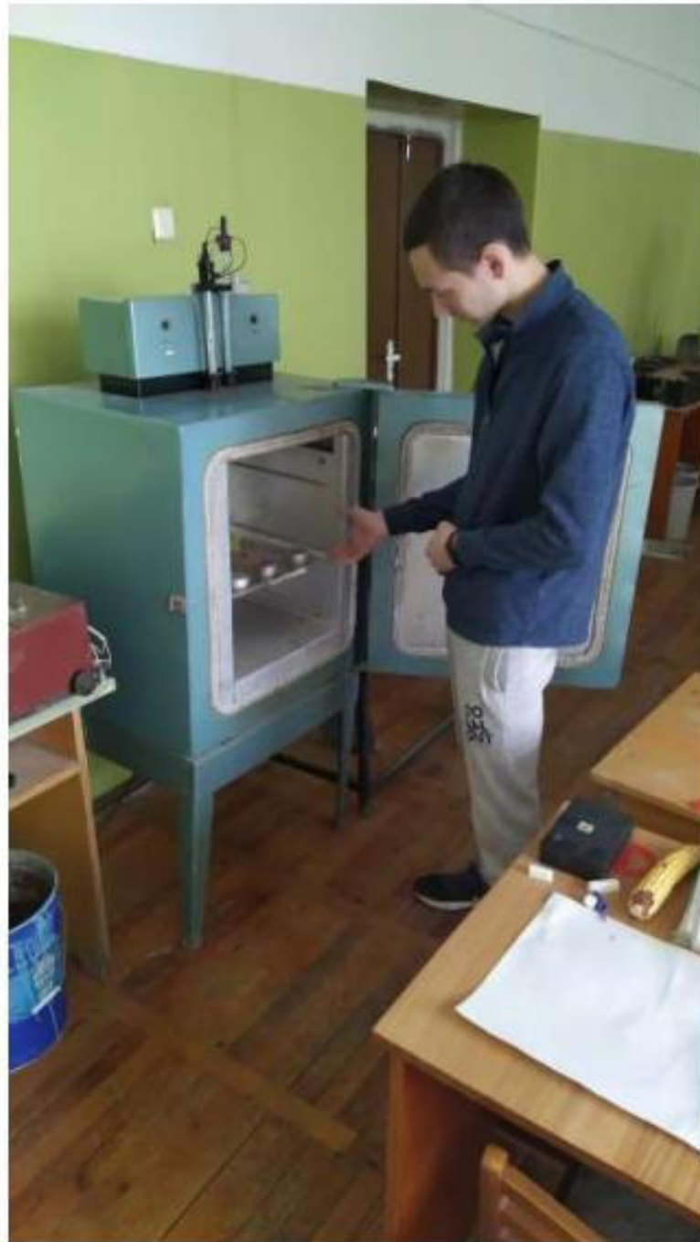
Рисунок 4.2 – Процесс помещения весовых стаканчиков в сушильный шкаф.
