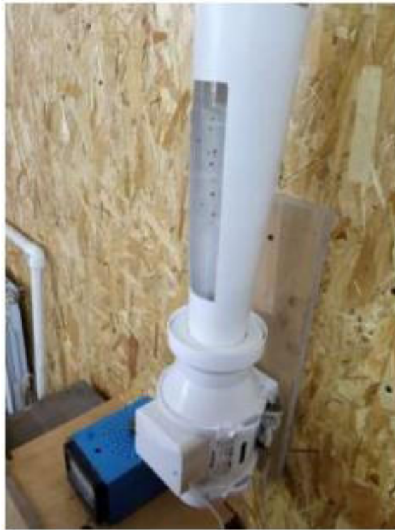
Рисунок 4.6 – Момент витания гранулы суперфосфата.
