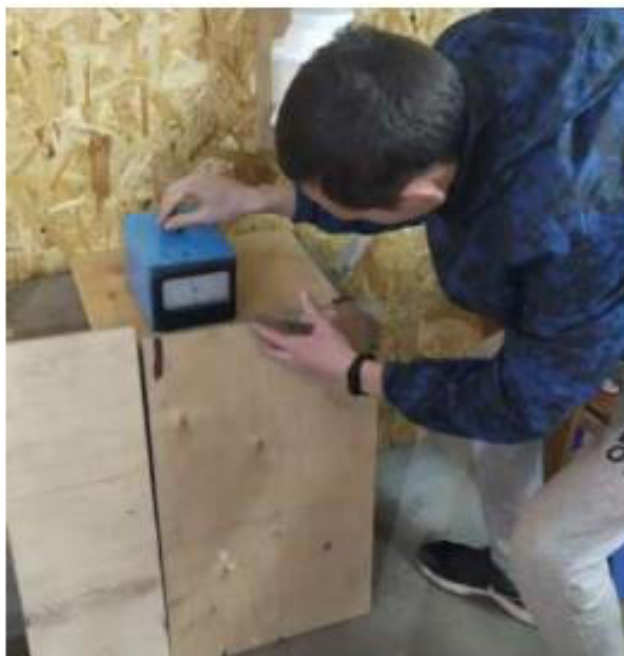
Рисунок 4.4 – Регулировка скорости воздушного потока
