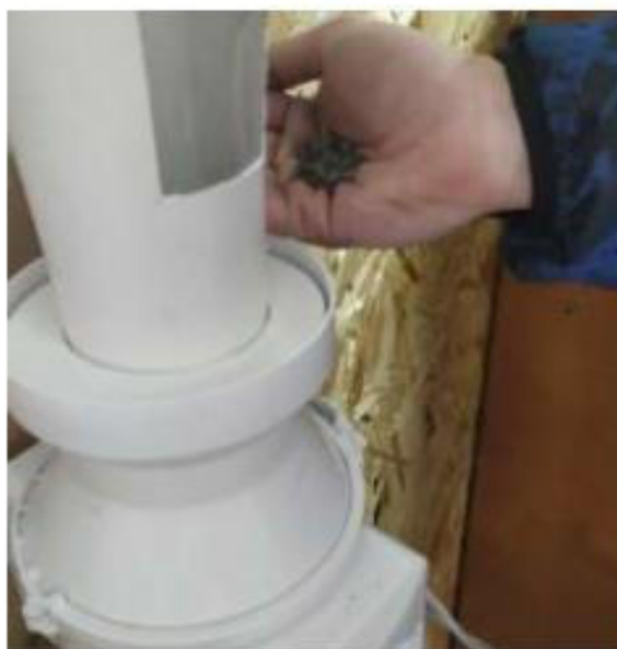
Рисунок 4.5 – Подача исследуемого материала в воздушный канал.
