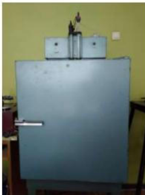
Рисунок 3.1 – Шкаф сушильный стерилизационный ШСС – 80п, термометр ТПК-М
