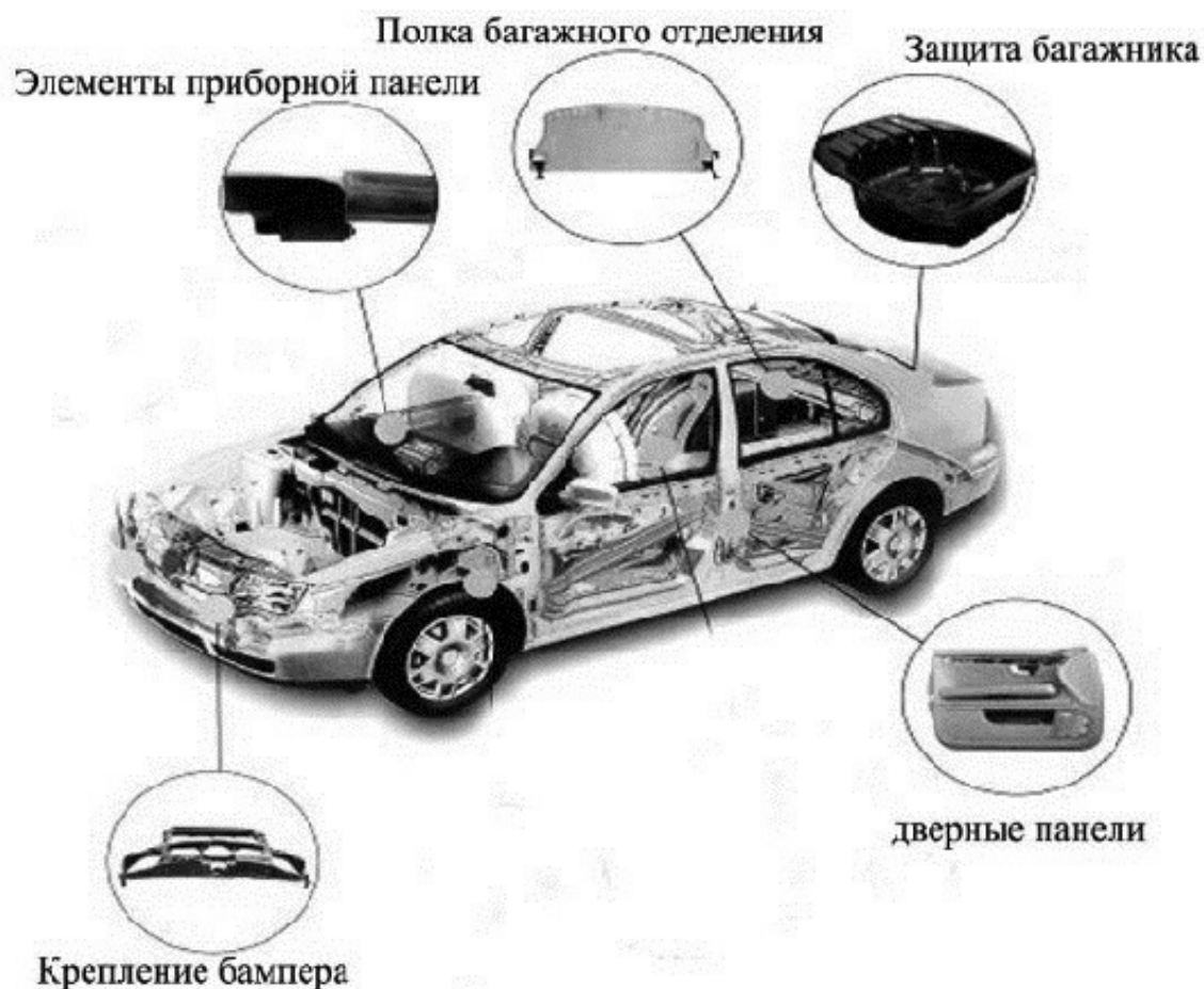
Рисунок 1.7 - Древесно-полимерные композиты с термопластичной матрицей в автомобилестроении
