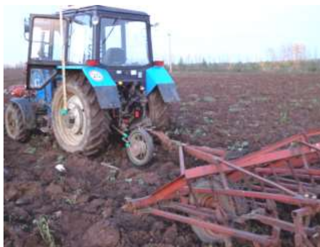
Рисунок 3.2 – Общий вид МТА в составе трактора МТЗ-82 и культиватора КПС-4
