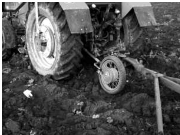
Рисунок 3.13 – Оборудование для измерения оборотов ведущего и копирующего колес
