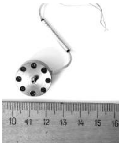
Рисунок 3.10 – Датчик давления индуктивный дифференциальный малогабаритный ДМИ-0,1-2.
