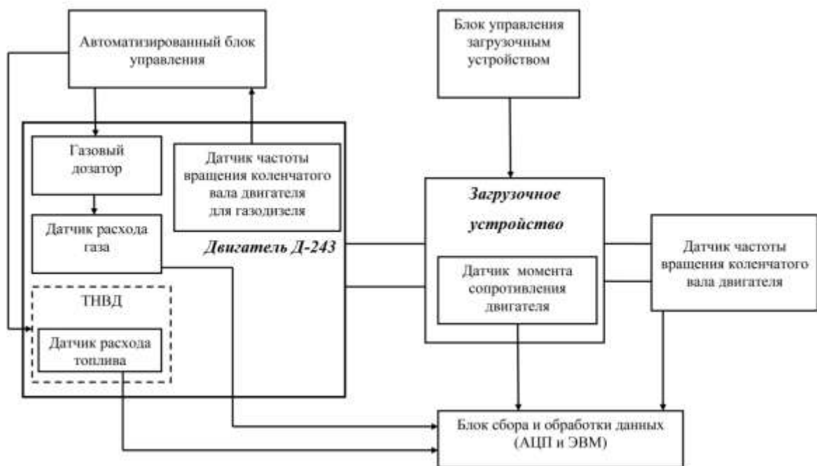
Рисунок 3.3 - Схема автоматизированного комплекса сбора и обработки данных.
