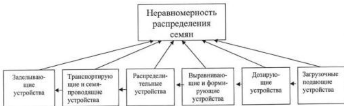
Рисунок 1.1 – Схема технологического процесса высева семян в сеялках централизованного высева
