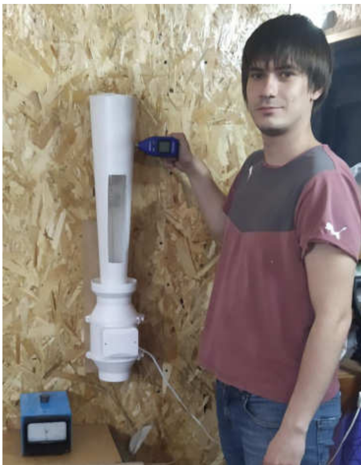
Рисунок 4.3 – Экспериментальная лабораторная установка для определения аэродинамических свойств.
