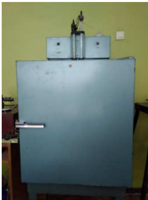
Рисунок 3.1 – Шкаф сушильный стерилизационный ШСС-80п, термометр ТПК-М
