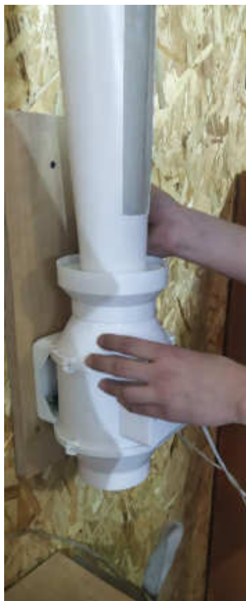
Рисунок 4.5 – Подача исследуемого материала в в воздушный канал.
