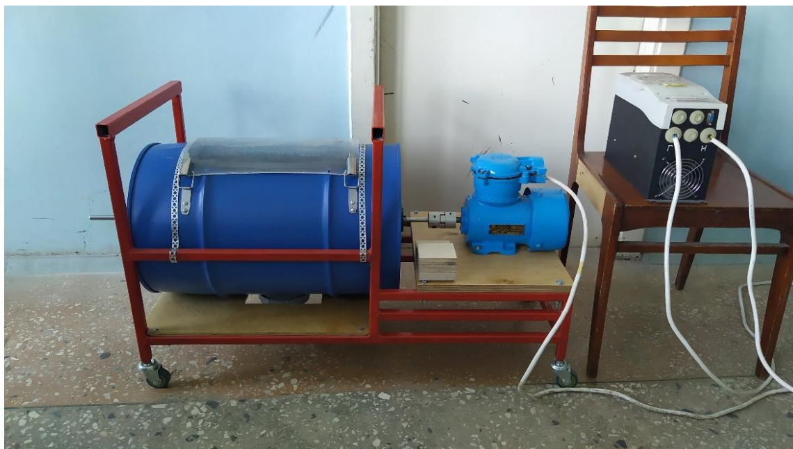
Рисунок 4.3 – Экспериментальная лабораторная установка с удвоенным рабочим органом пропеллерного типа для определения однородности смеси.
