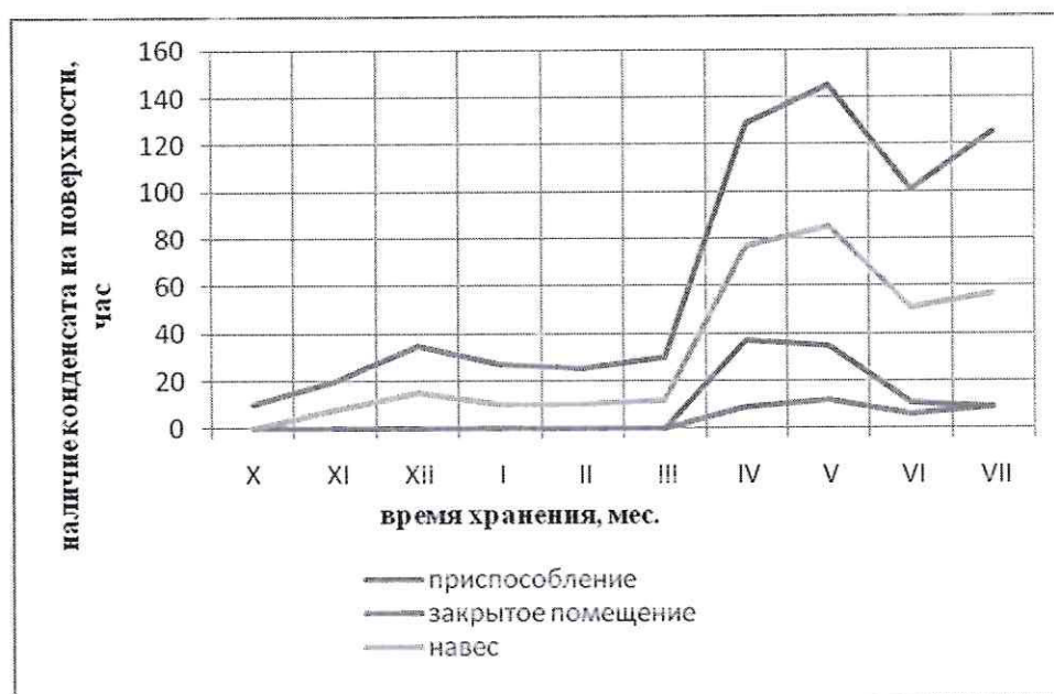
Рисунок 4.7 - Суммарное время наличия конденсата на поверхности машины
