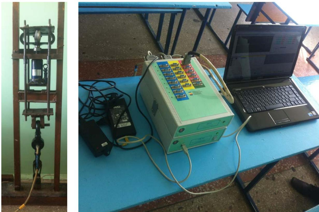
Рисунок 3.1 – Приспособление для тарировки тягового тензозвена и измерительное оборудование
