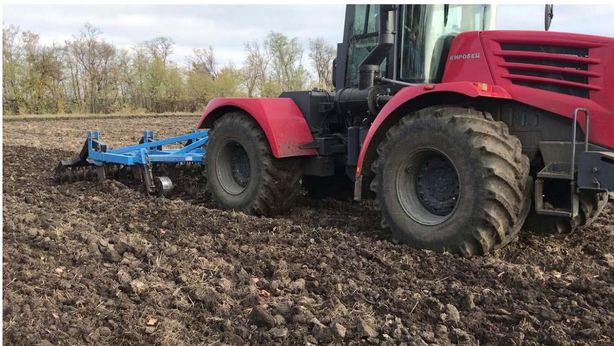
Рисунок 4.3 – Трактор К-744Р4 с глубокорыхлителем
