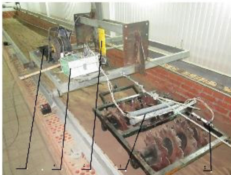
1 – груз; 2 – ЭВМ; 3 – станции сбора данных ИП-264 с модулем согласования МС-5; 4 – тензобалка; 5 – датчик
