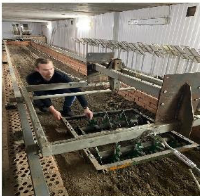
1 – электродвигатель, 2 – редуктор, 3 – барабан, 4 – частотный преобразователь, 5 – тележка, 6- тензометрическая балка, 7 – трос
