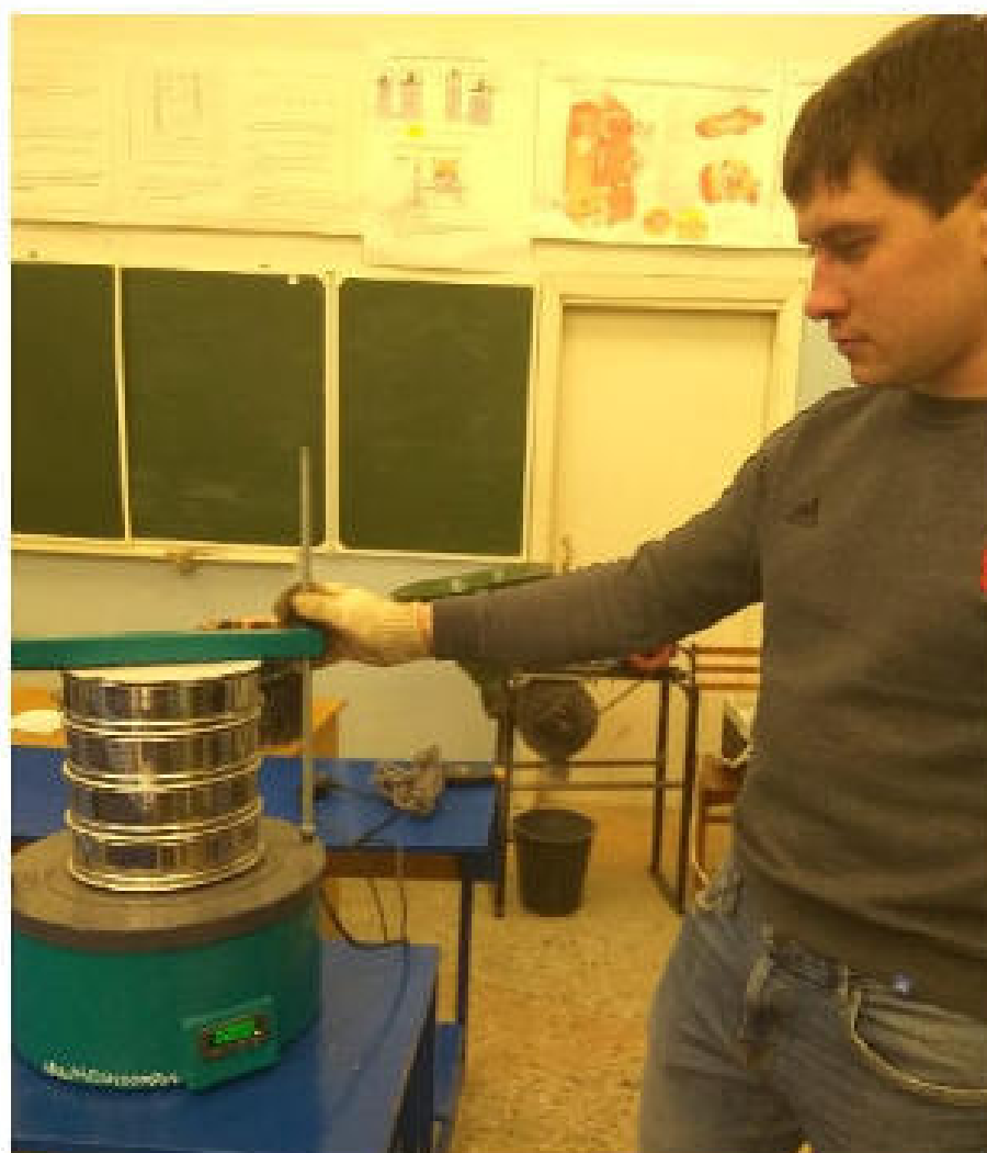
Рисунок 3.2 – Анализатор ситовый А20
