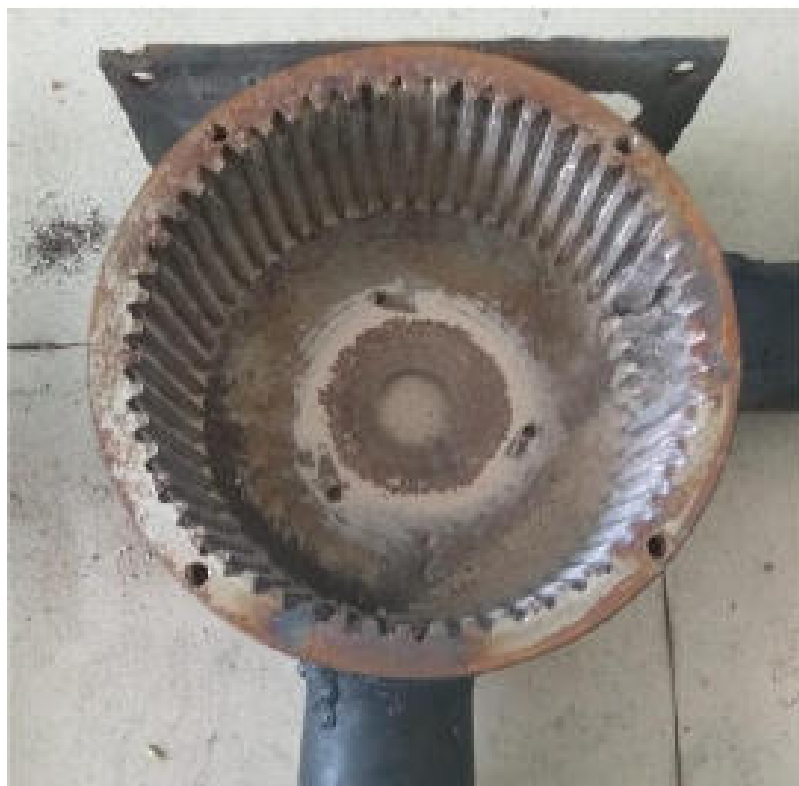
Рисунок 2.3 – Расположение бичей в безрешетной молотковой дробилке
