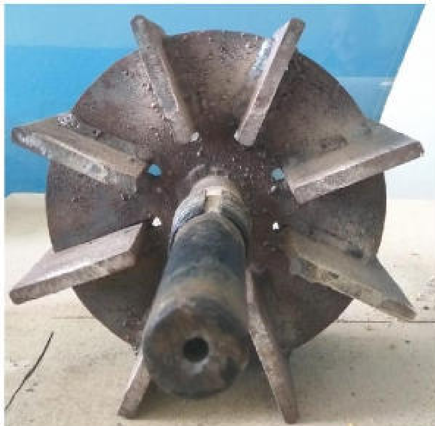
Рисунок 2.5. Схема расположения неподвижных молотков барабана.
