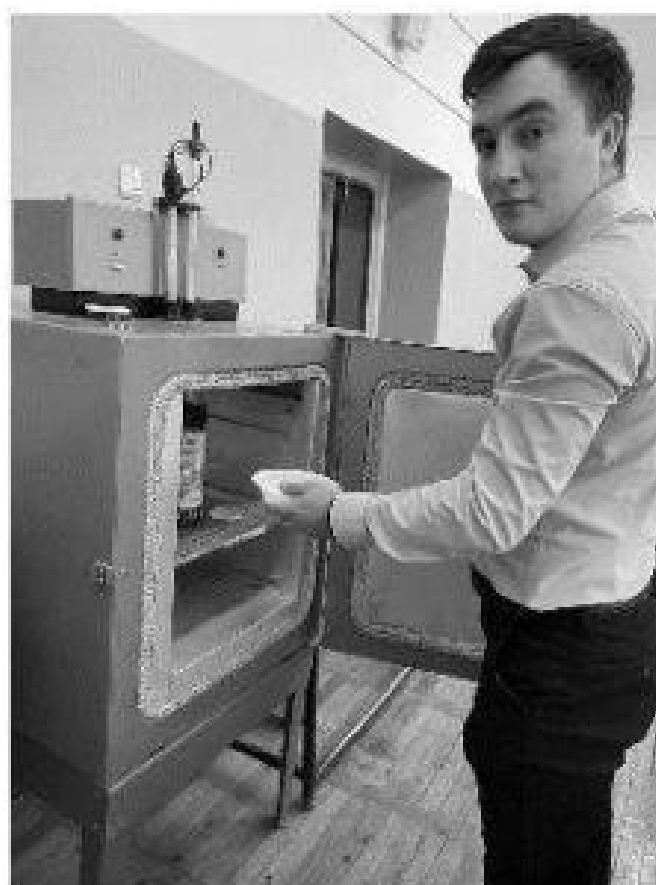
Рисунок 3.2 – Определение влажности зерна гречихи
