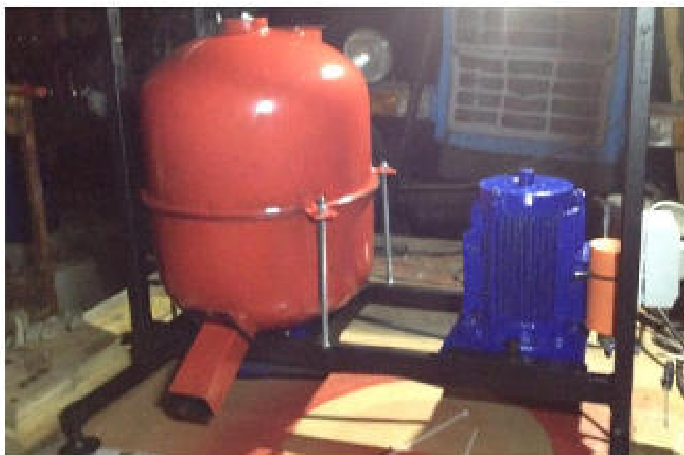
Рисунок 4.1 – Смеситель концентрированных кормов во время испытаний.
