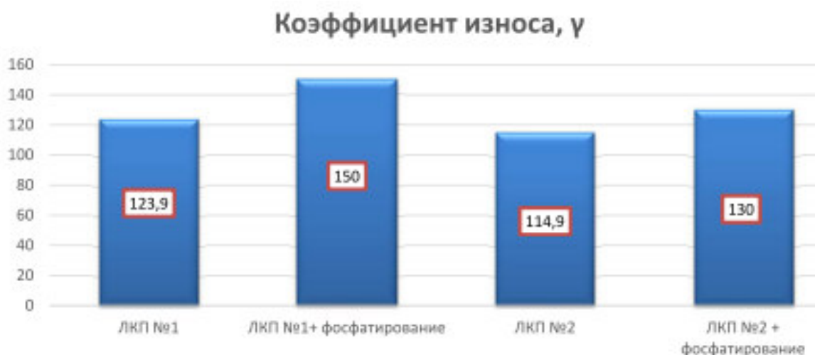
Рисунок № 4.5 – Износостойкость ЛКП №1 и ЛКП №2.
