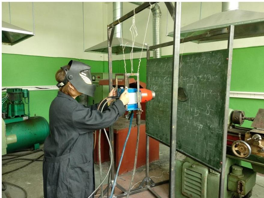
Рисунок 2.1. Дуговая металлизация лабораторных образцов
