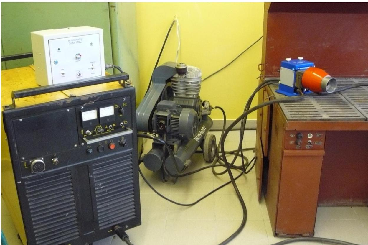
Рисунок 3.6 – Установка для дуговой металлизации
