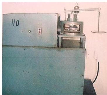
Рисунок 3.2 - Машина трения 77МТ-1
