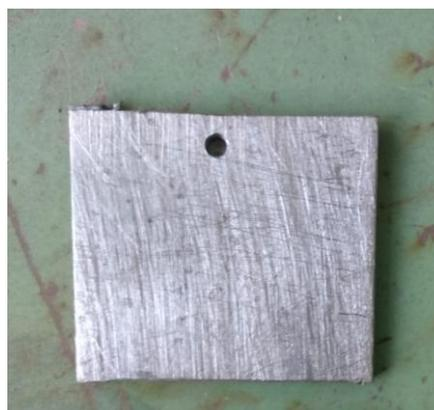
Образец №1 с нанесением карбид бора ( $B_4C$ ), криолита ( $Na_2AlF_6$ ).
