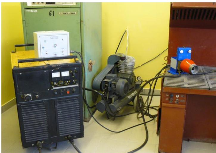
Рисунок 1. Установка для электродуговой металлизации
