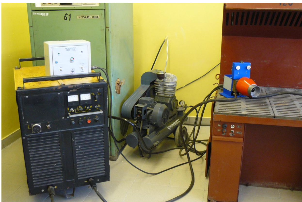
Рисунок 3.5 – Установка для дуговой металлизации стрелчатых лап
