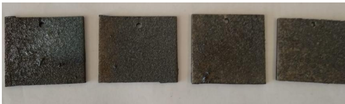
Рисунок 4.2. Общий вид всех образцов после сверхзвуковой металлизации с различными составами металлокерамических порошков.
