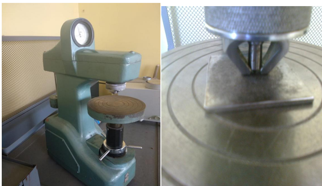
Рисунок 4.3 – Схема определения твердости поверхности
