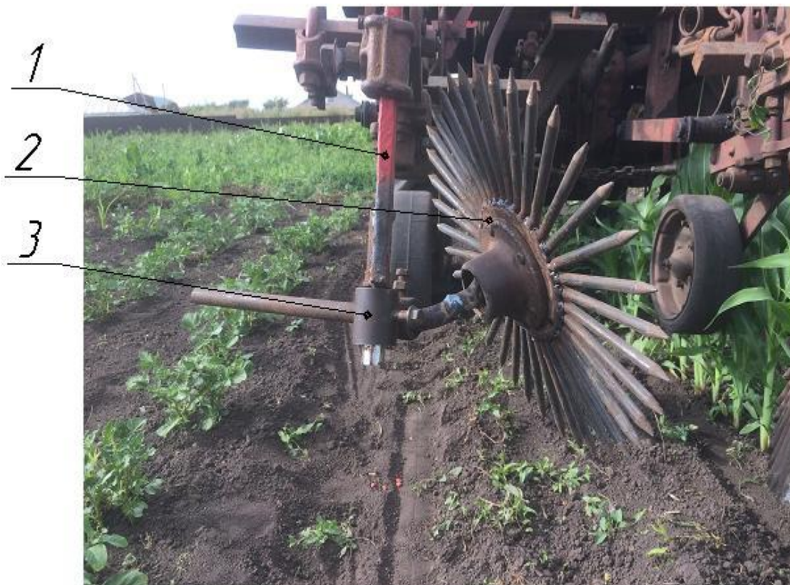
1- Стойка, 2- игольчатый рабочий орган, 3- шарнирный узел
