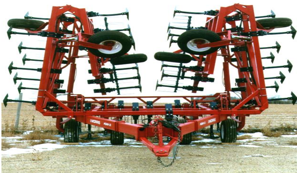
Рисунок 1.13 - Широкозахватный культиватор Magnum III фирмы «Morris» (Канада)
