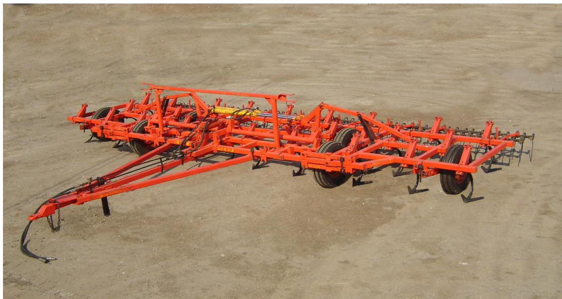
Рисунок 1.11 - Культиватор бесцепочный для сплошной обработки почвы КШУ-12-01
