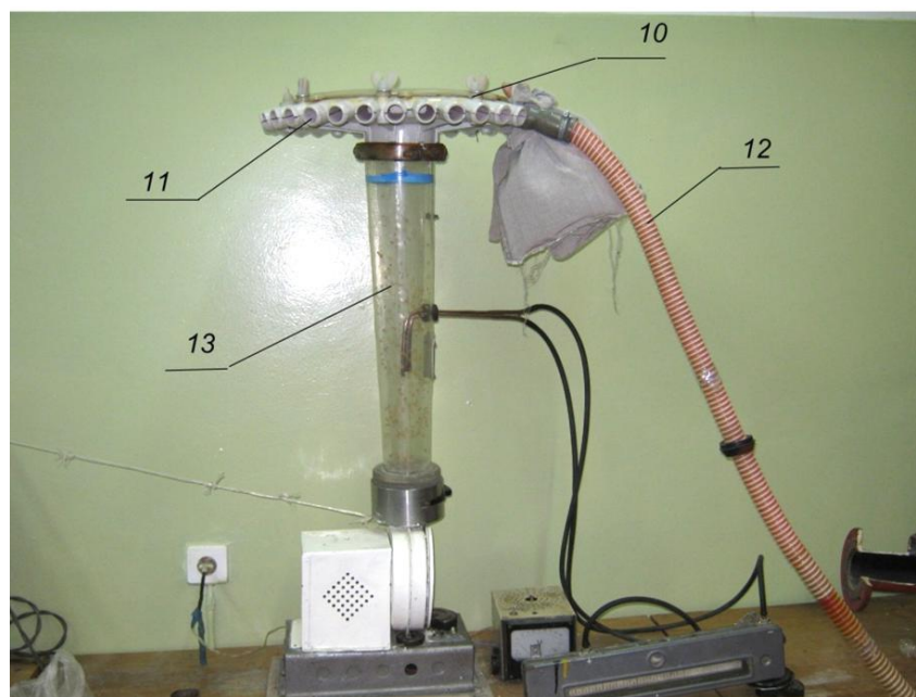
10 – распределитель семян; 11 – отводящие патрубки; 12 – семяпровод; 13 – семявоздушная смесь.
