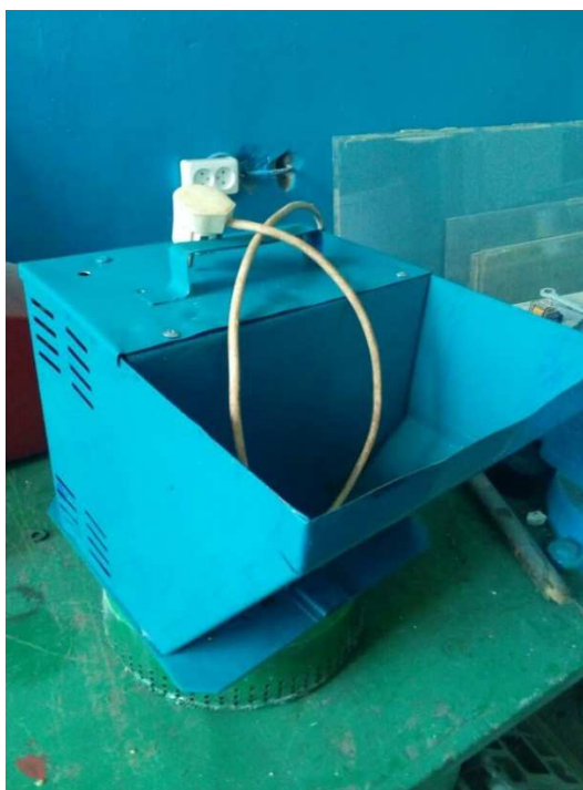
Рисунок 2.2 - Общий вид устройства для дробления зерна
