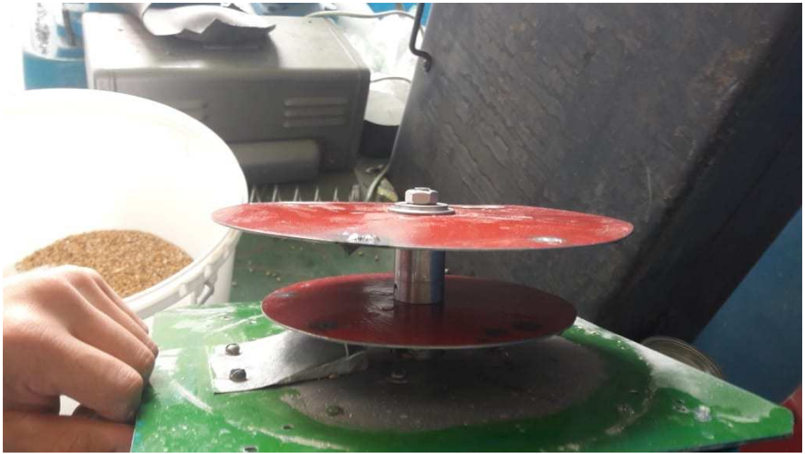
Рисунок 2.3 – Расположение лопастных дисков на валу электродвигателя
