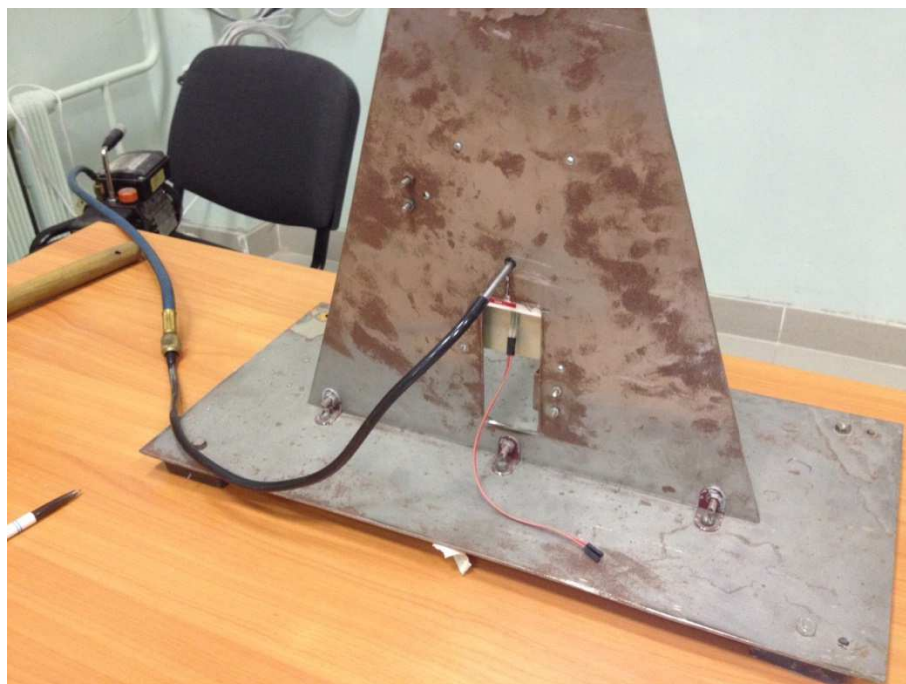
Рисунок 4.3 – Экспериментальная лабораторная установка подключенная к вакуумному компрессору
