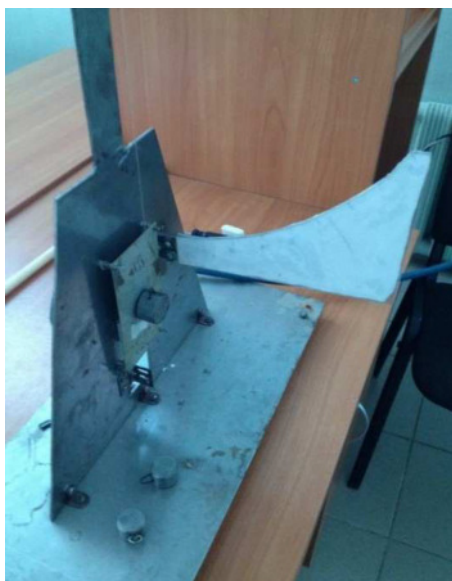
Рисунок 4.1 – Экспериментальная лабораторная установка для определения средней силы разрушения зерна
