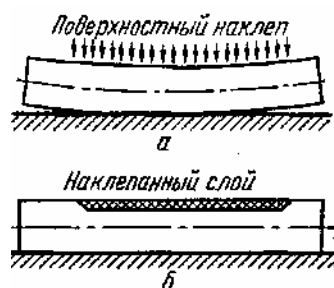
Рисунок 3.2 - Схема правки бруса местным поверхностным наклепом:
