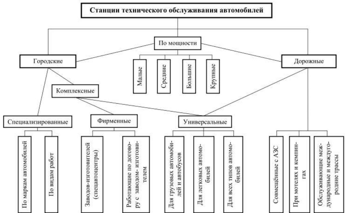
Рис. 1.1 Классификация станций технического обслуживания автомобилей
