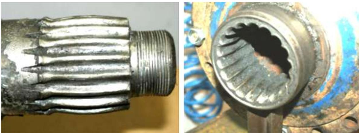
Рисунок 1.3 - Износ деталей неподвижного шлицевого соединения.
