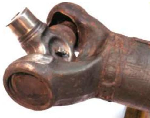
Рисунок 1.2 - Износ шипов крестовин и разрушение стакана подшипника.
