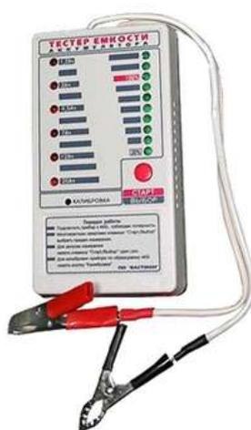
Рисунок 1.2 Тестер контроля емкости АКБ SKAT-T
