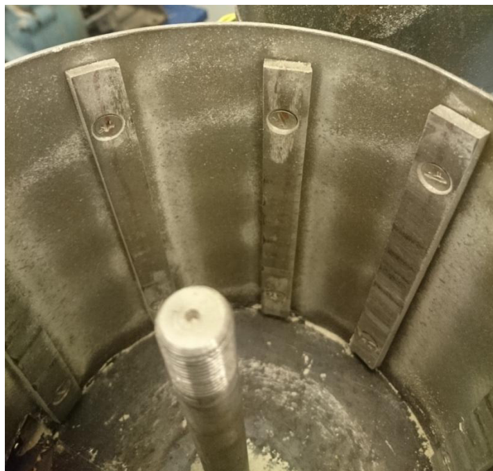
Рисунок 3.5 Расположение бичей в безрешетной молотковой дробилке
