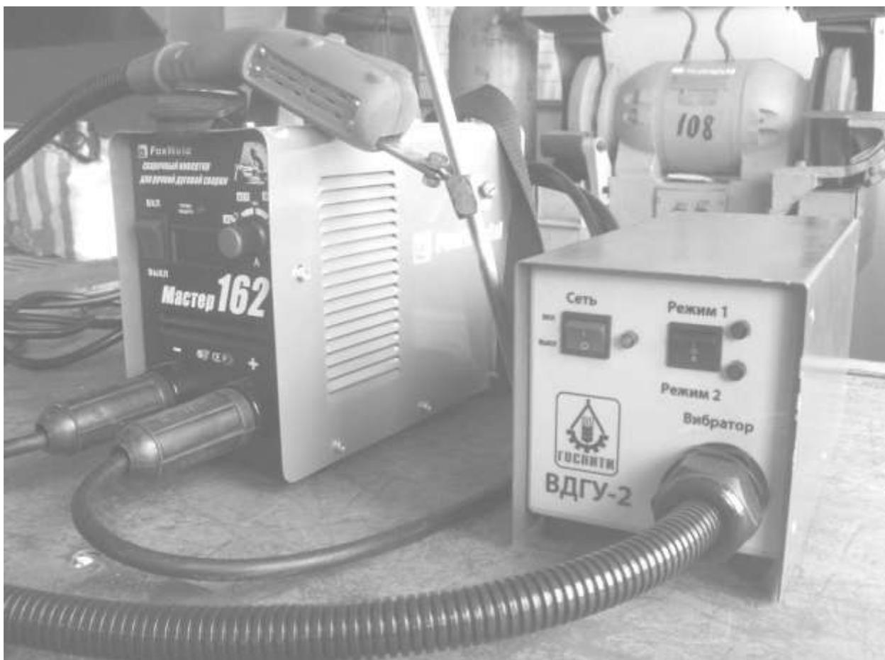
Рисунок 3.1. - Общий вид установки для вибродугового упрочнения ВДГУ-2
