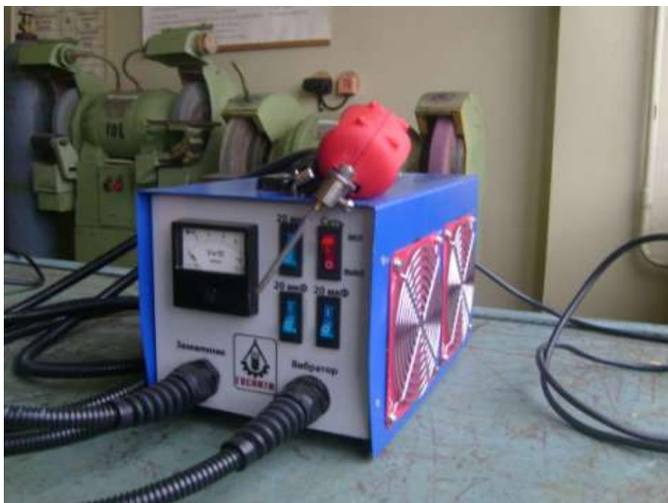
Рисунок 2.1 - Общий вид устройства для электроискрового упрочнения деталей машин
