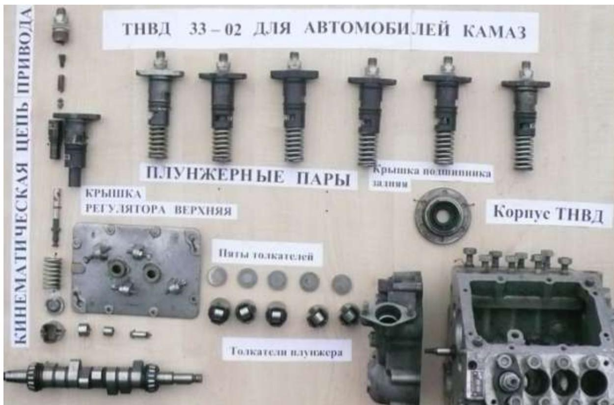
Рисунок 1.1 – Кинематическая силовая цепь топливного насоса высокого давления
