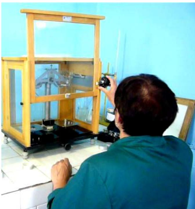
Рисунок 3.4 – Фотография процесса предварительного замера весов образцов на весах модели ВЛР-1
