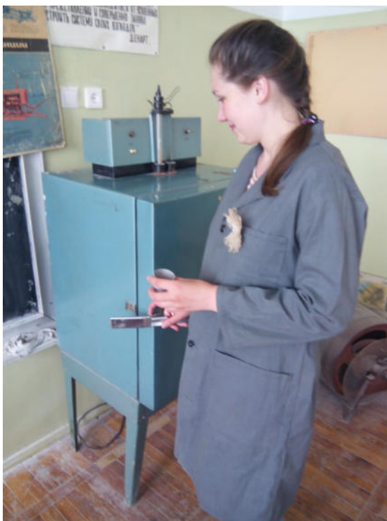
Рисунок 4.2 – Процесс помещения бюксов в сушильный шкаф
