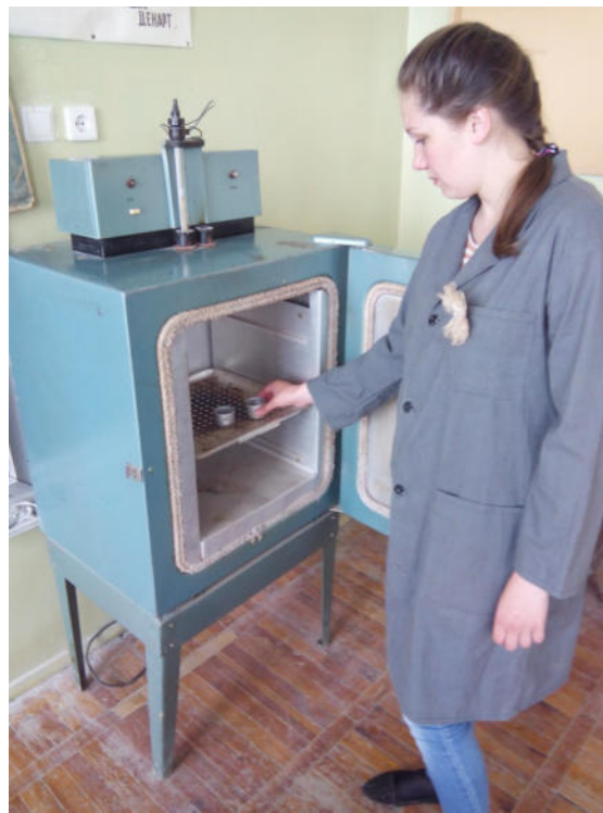
Рисунок 4.2 – Процесс помещения бюксов в сушильный шкаф
