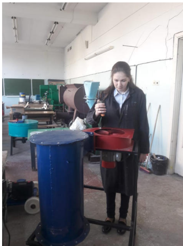
Рисунок 4.8 – Измерение частоты вращения вентилятора
