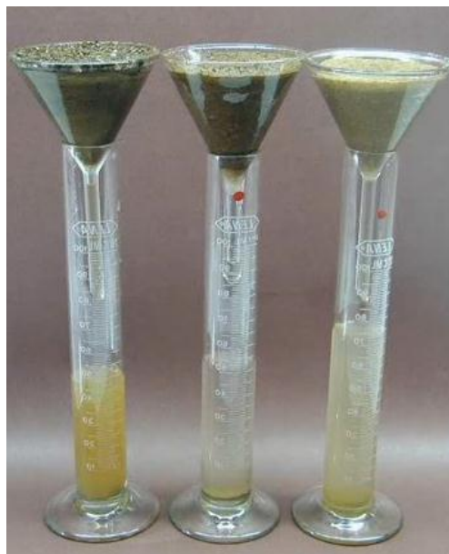
Рисунок 2.14 – определения влажности почвы, путем фильтрации определенного объема воды через известный объем почвы
