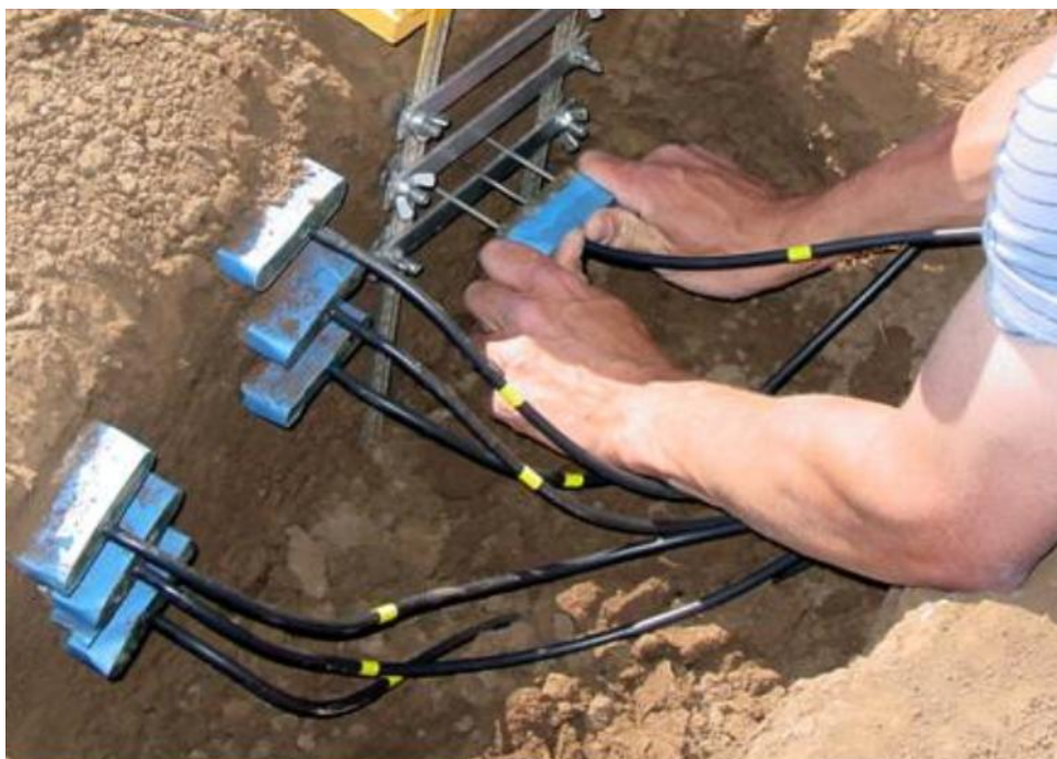
Рисунок 2.16 – Многократные показания влажности почвы по всей корневой зоне - Датчик влажности почвы типа электропроводности
