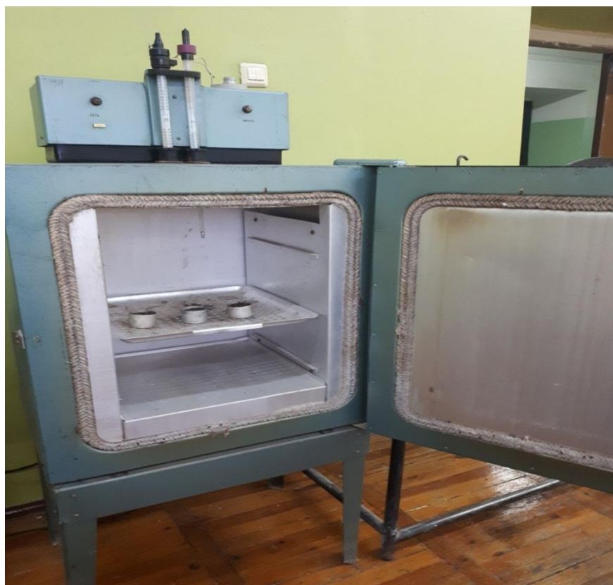
Рисунок 3.16 – печная сушка образцов почвы
