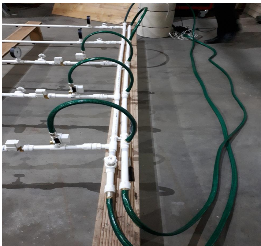
Рисунок 3.7 – подключение электромагнитных клапанов для автоматизации системы
