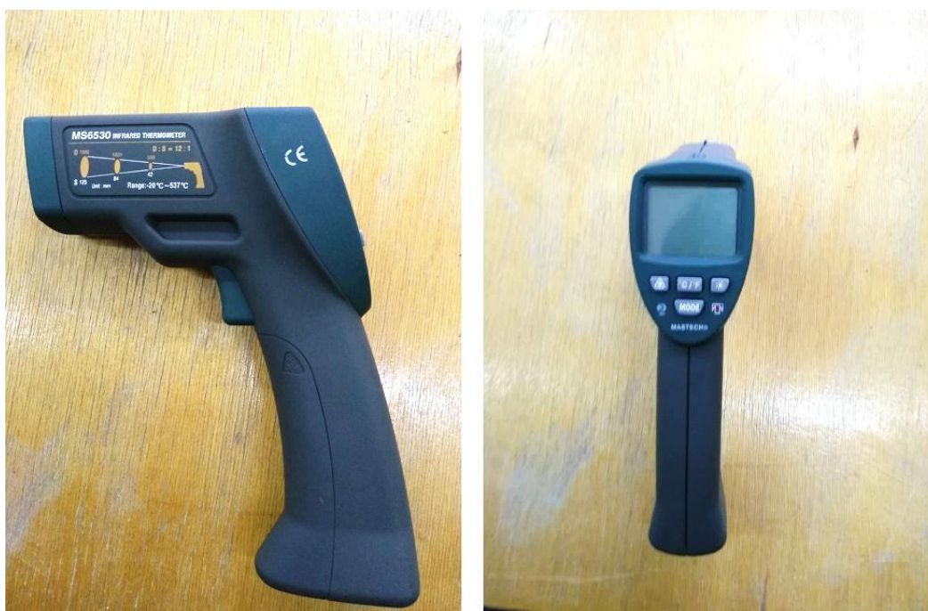
Рисунок 3.18 – Дистанционный измеритель температуры (пирометр) MS6530
