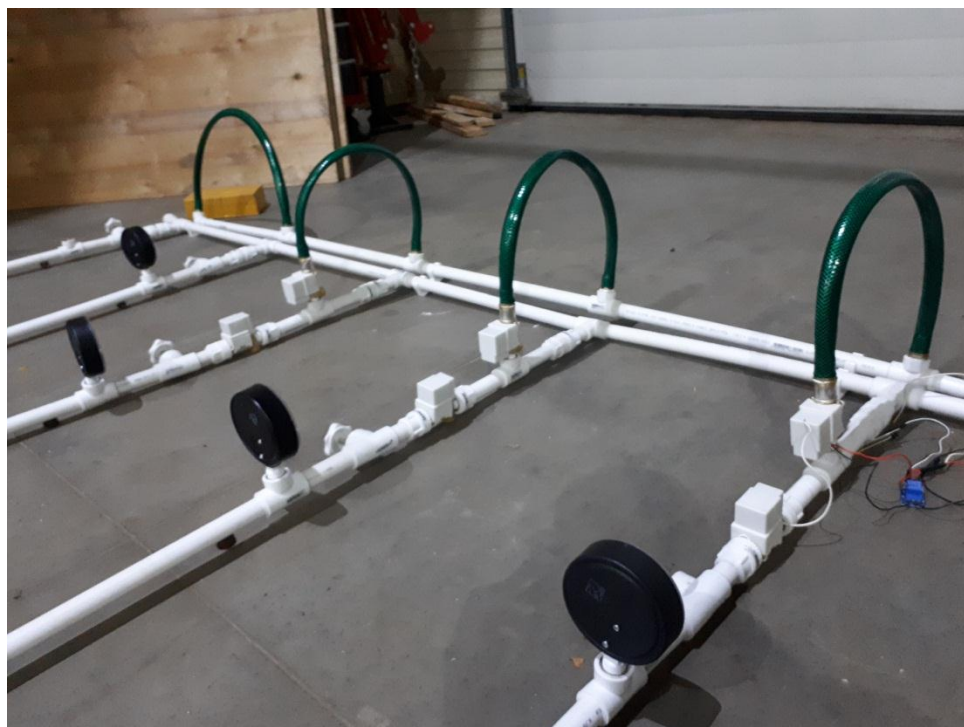
Рисунок 3.6 – подключение электромагнитных клапанов для автоматизации системы
