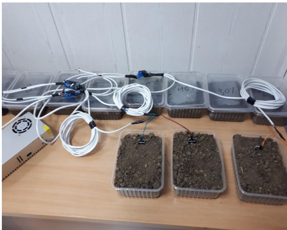
Рисунок 3.15 – Измерение времени отклика датчиков влажности почвы
