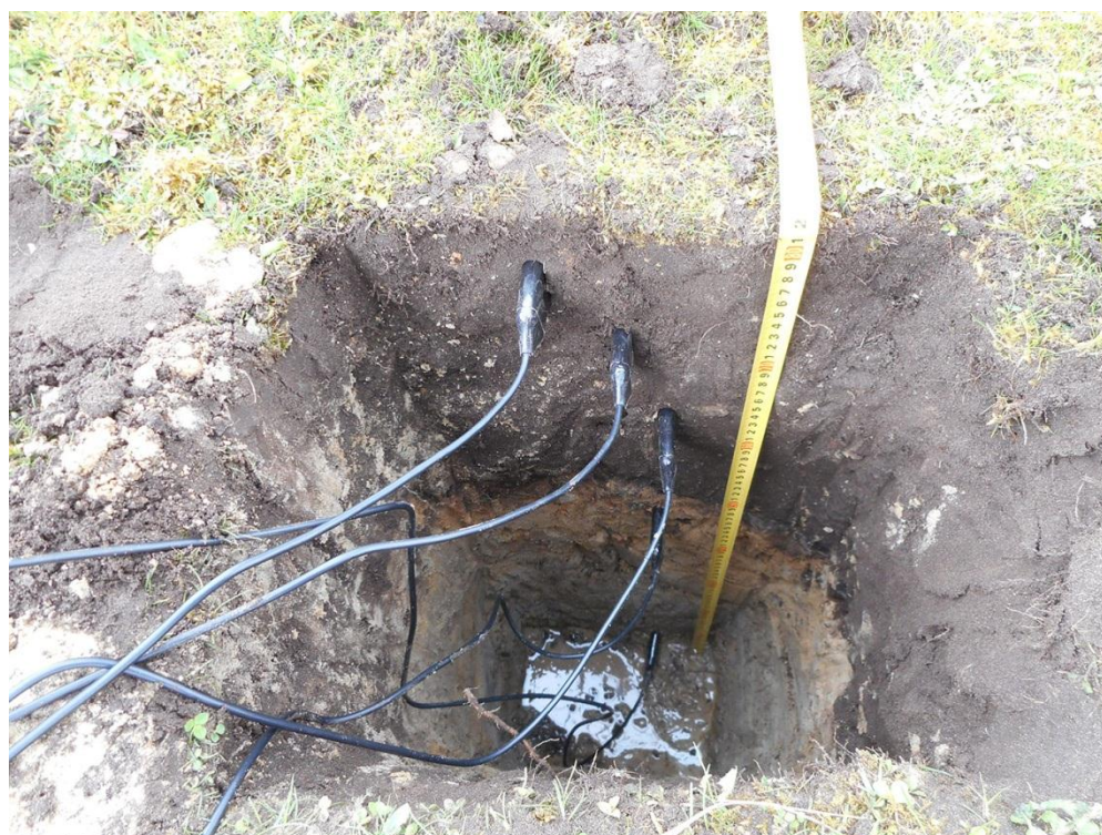
Рисунок 2.17– Многократные показания влажности почвы- Датчики влажности почвы Decagon 5TM диэлектрические зонды TDR (емкостные)
