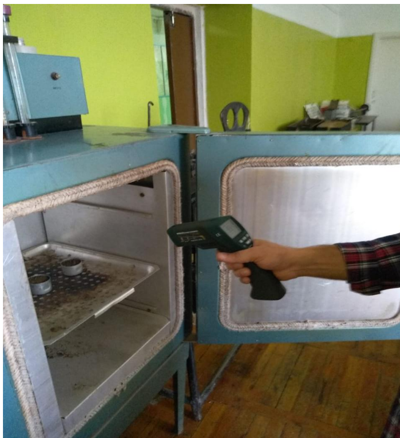
Рисунок 3.17 – проверка температуры внутри сушильного шкафа с помощью инфракрасного термометра MS6530
