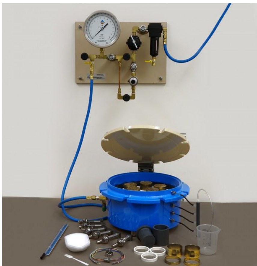
Рисунок 2.13 – экстрактор давления, содержащий образцы почвы для определения влажности почвы при различных уровнях давления всасывания.
