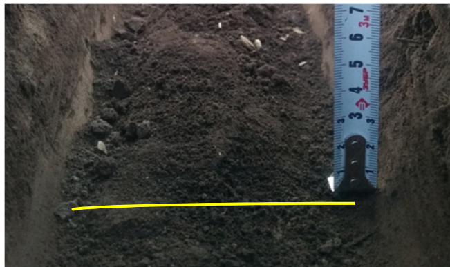
Рисунок 4.3 – Профиль дна на глубине обработки 0,07 м, образованный между дисками с радиусом 0,30 м при их установке на расстоянии d = 0,10 м и угле между дисками \gamma = 12^\circ
