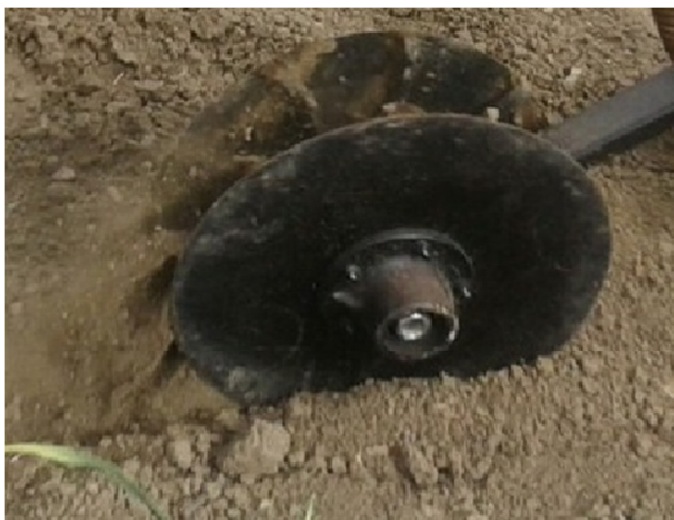
Рисунок 4.4 – Сход почвы с дисков при расстоянии d = 0,20 м и скорости движения рабочего органа v = 3 м/с
