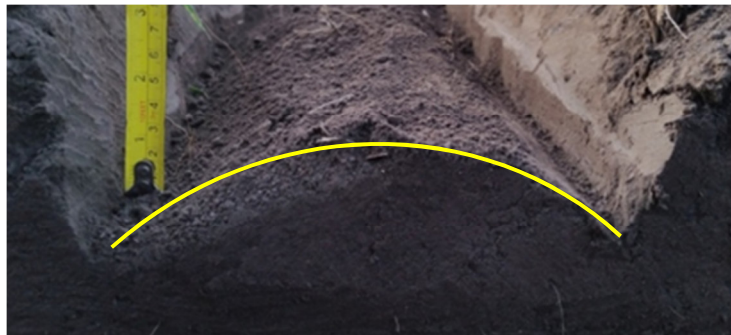
Рисунок 4.2 – Профиль дна на глубине обработки 0,07 м, образованный между дисками с радиусом 0,30 м при их установке на расстоянии d = 0,20 м и угле между дисками \gamma = 3^\circ
