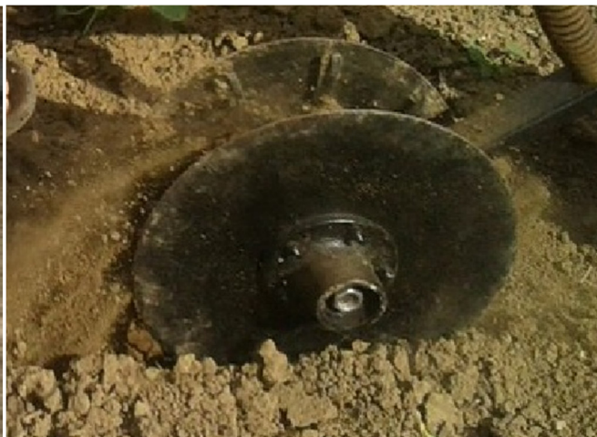
Рисунок 4.5 – Сход почвы с дисков при расстоянии d = 0,10 м и скорости движения рабочего органа v = 3 м/с
