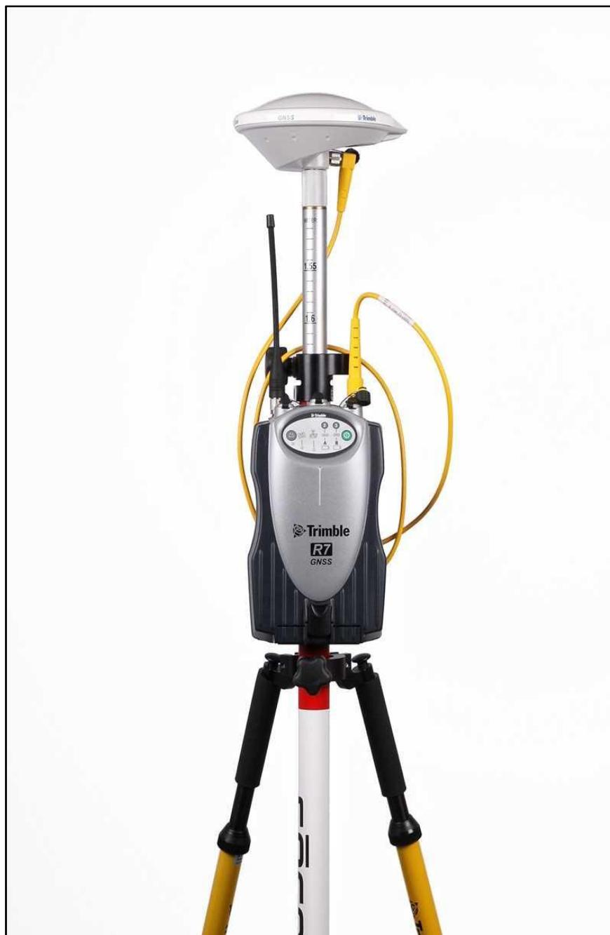
Рисунок 2. ГНСС приёмник Trimble R7
