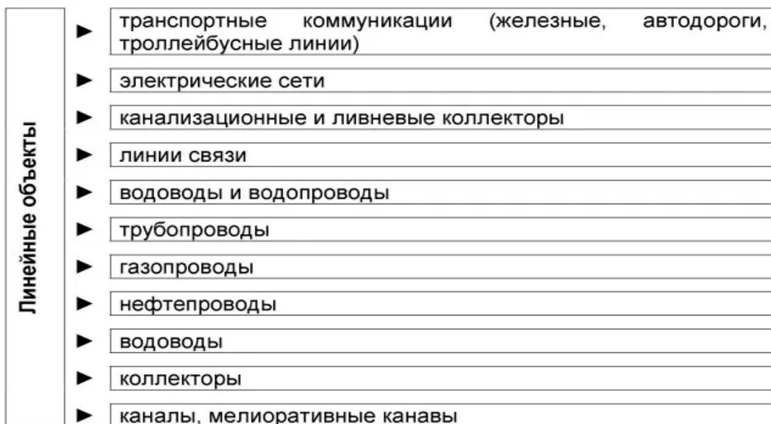
Рис.2 - Классификация будет линейных объектов в зависимости от назначения
