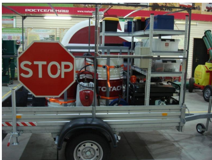
Рисунок 3.3- Агрегат сервисный прицепной АСП-1 на базе автомобильного прицепа МЗСА 817701.004 для технического обслуживания и ремонта сложной самоходной и прицепной сельскохозяйственной техники. (вид слева)
