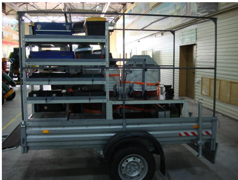
Рисунок 3.2- Агрегат сервисный прицепной АСП-1 на базе автомобильного прицепа МЗСА 817701.004 для технического обслуживания и ремонта сложной самоходной и прицепной сельскохозяйственной техники(вид справа)
