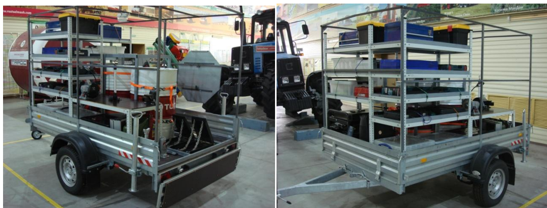
Рисунок 3.1- Агрегат сервисный прицепной АСП-1 на базе автомобильного прицепа МЗСА 817701.004 для технического обслуживания и ремонта сложной самоходной и прицепной сельскохозяйственной техники.
