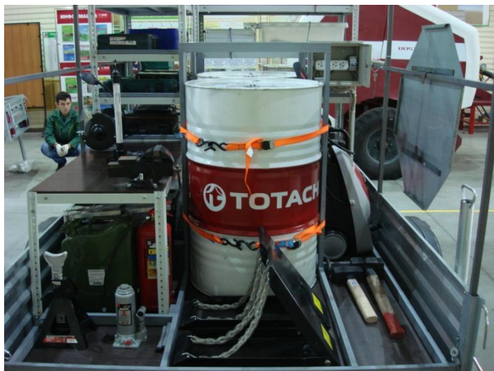
Рисунок 3.4- Агрегат сервисный прицепной АСП-1 на базе автомобильного прицепа МЗСА 817701.004 для технического обслуживания и ремонта сложной самоходной и прицепной сельскохозяйственной техники. (вид сзади)
