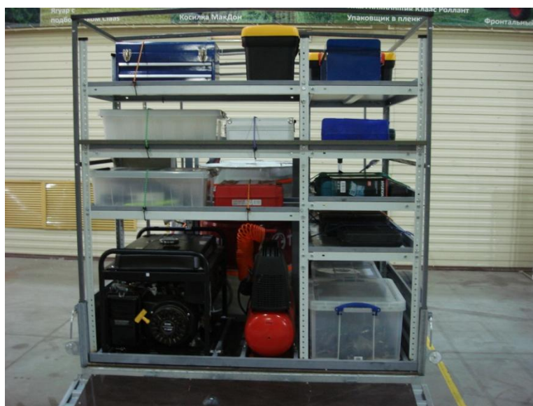
Рисунок 3.5- Агрегат сервисный прицепной АСП-1 на базе автомобильного прицепа МЗСА 817701.004 для технического обслуживания и ремонта сложной самоходной и прицепной сельскохозяйственной техники. (вид спереди)
