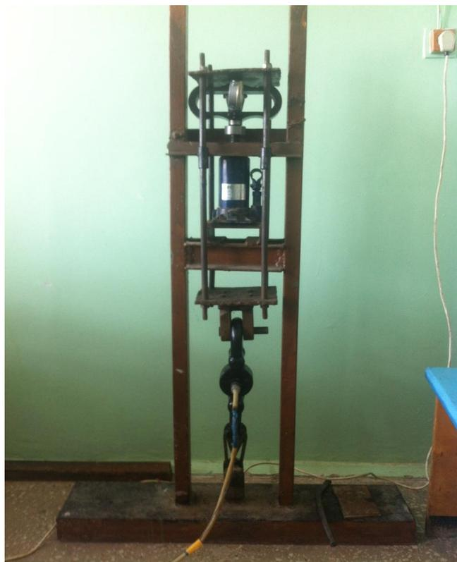
Рисунок 3.1 – Приспособление для тарировки тягового тензозвена
