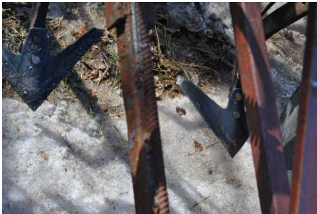
Рисунок 4.2. Парная установка опытной упрочненной и серийной новой стрельчатой лапы
