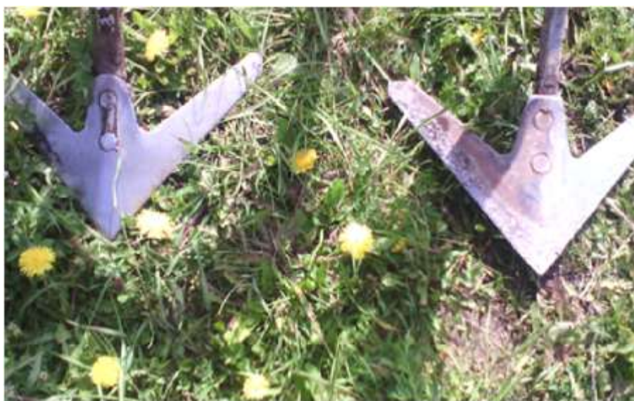
Рисунок 4.5 Упрочненные и серийные стрелчатые лапы после наработки опытного культиватора 600 га
