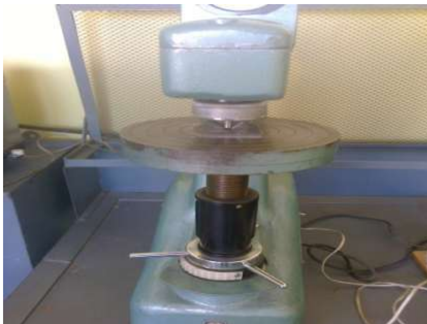
Рисунок 2.2 Твёрдомер Роквелла ТК-2
