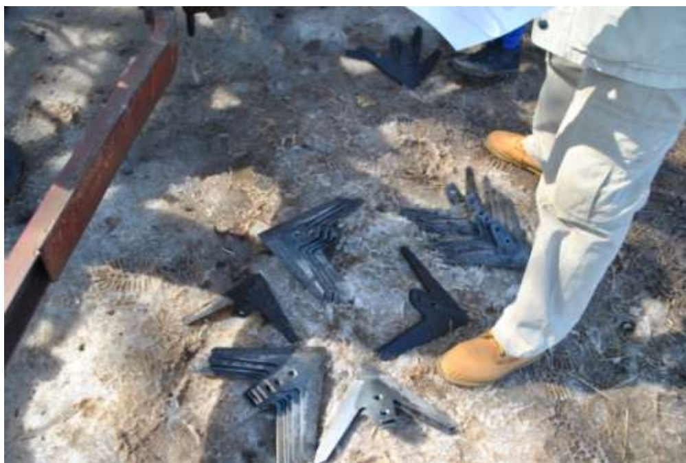
Рисунок 4.1. Упрочненные стрельчатые лапы типа размера 330 перед установкой на культиватор КПС-4
