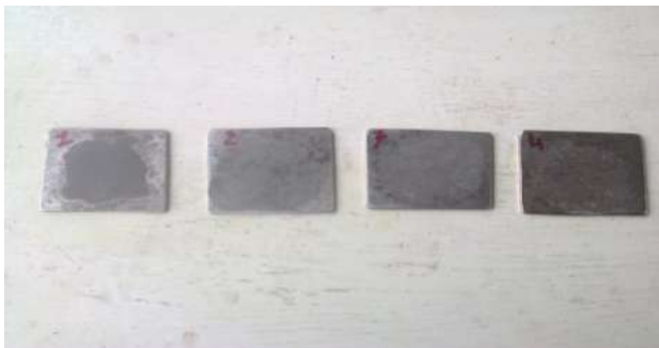
Рисунок 3.8. Общий вид образцов после проведения виброуглового упрочнения
