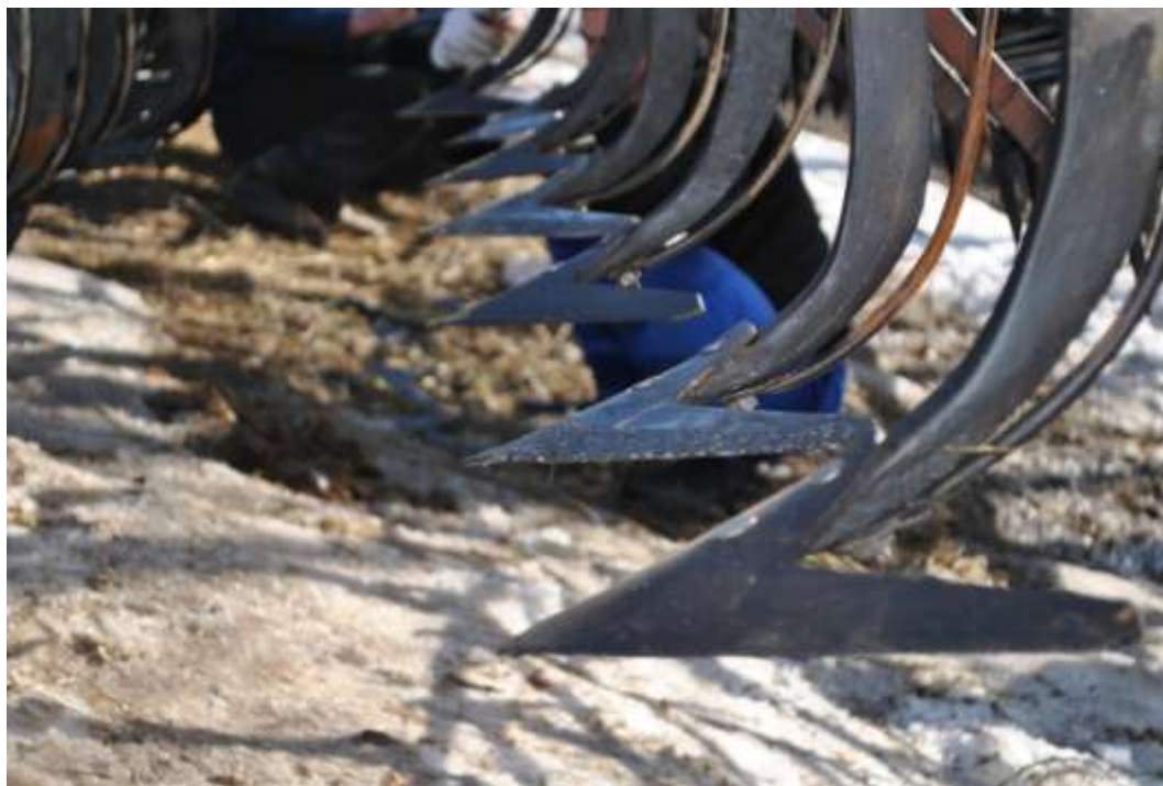
Рисунок 4.3. Подготовленный к полевым условиям опытный культиватор КПС-4
