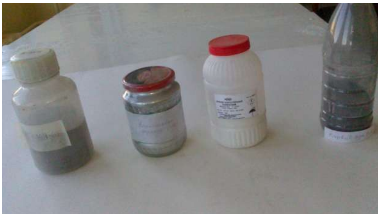
Рисунок 3.2 – Компоненты металлокерамических композиций
