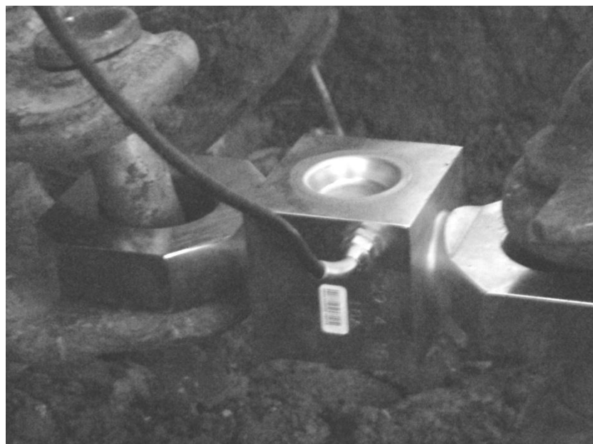
Рисунок 3.10 – Тензодатчик ТСА для определения тягового усилия на крюке трактора
