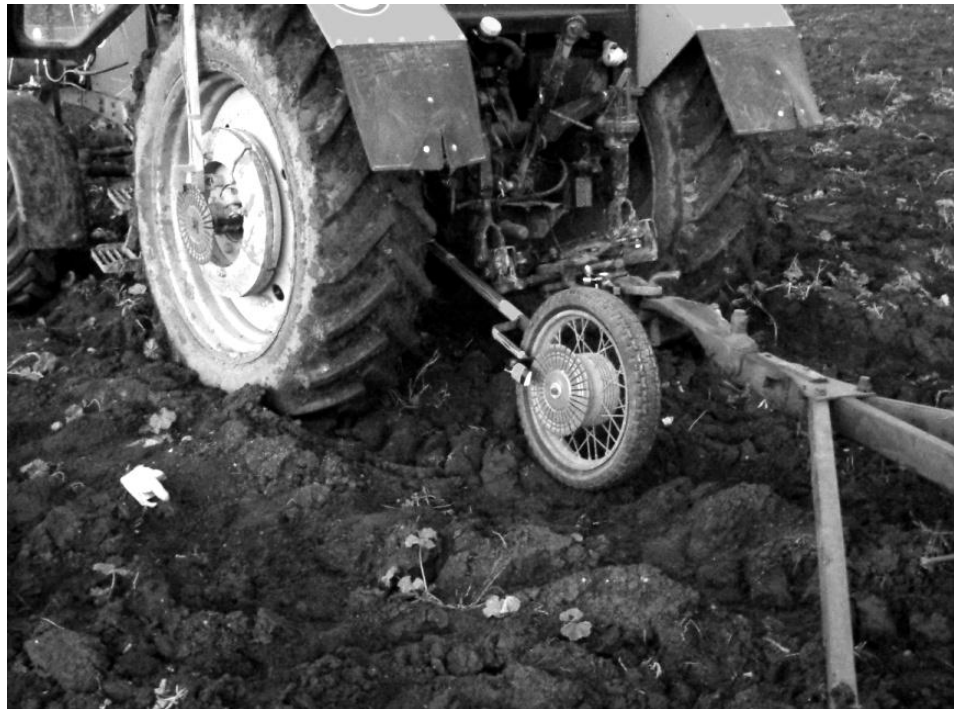
Рисунок 3.9 – Внешний вид измерительных устройств для измерения оборотов ведущего и копирующего колес
