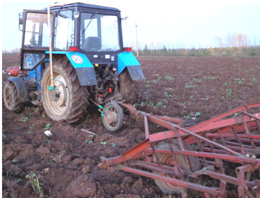
Рисунок 3.2 – Внешний вид экспериментальной установки (МТЗ-82 и культиватор КПС-4)
