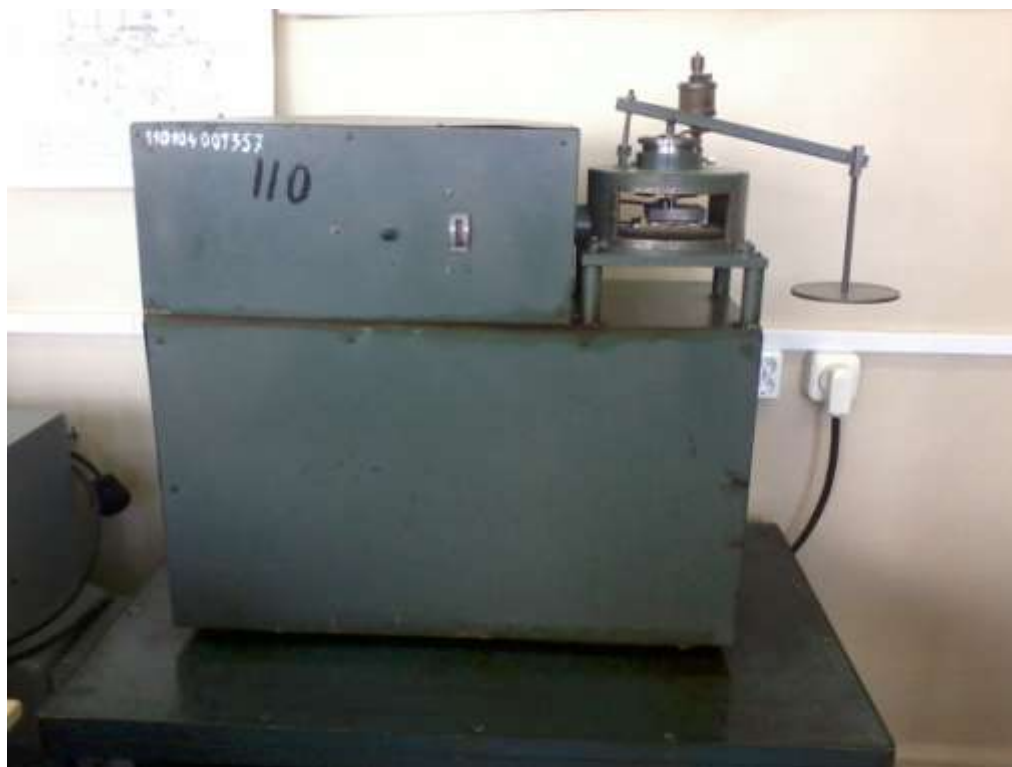
Рисунок 3.4 - Машина трения при испытание образца.
