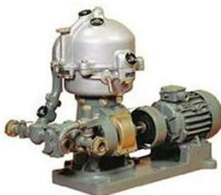
Рисунок 1.2 - центробежный сепаратор СЦ-1,5 (УОР-301У I-ОМ4)
