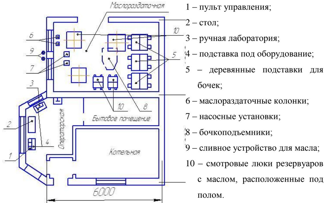
Рисунок 2.2 – План операторской с маслоскладом и маслораздаточной (нефтесклада емкостью 40, 80 и 150 м<sup>3</sup>)
