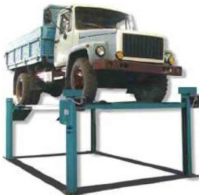
Рисунок 1.3 - Подъемник П 178Е-02.
