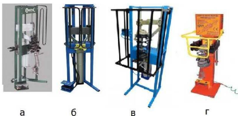
а - стяжка пружин стационарная Comras CSC (Дания); б - стяжка пружин макферсона с пневмоприводом СТ-G0108; в - универсальная установка СТ-G0108U; г - пневматический пресс для разборки амортизаторов SS0010 Комраст3
