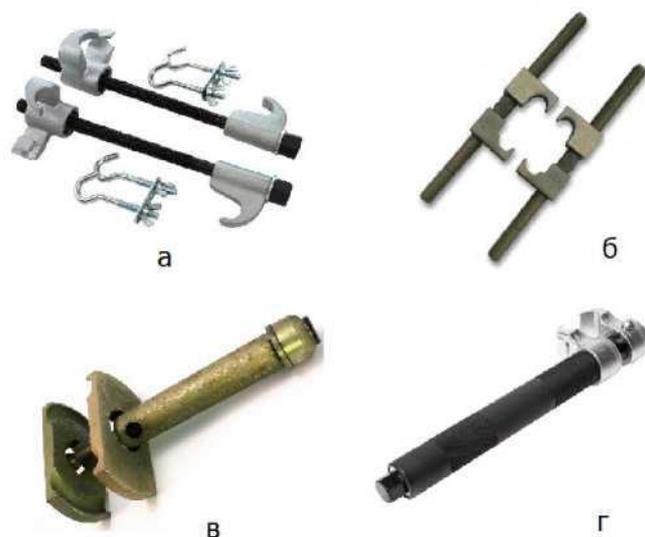
а - стяжка для пружин MacPherson; б - универсальная стяжка пружин; в - стяжка для пружин с центральной стяжкой; г - стяжка пружин JTC-1401
