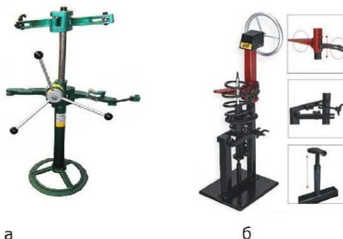
а - сжиматель пружин МТ 08108; б - стяжка пружин JTC-1404A (Тайвань)
