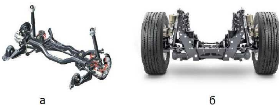
а - зависимая подвеска; б - независимая подвеска
