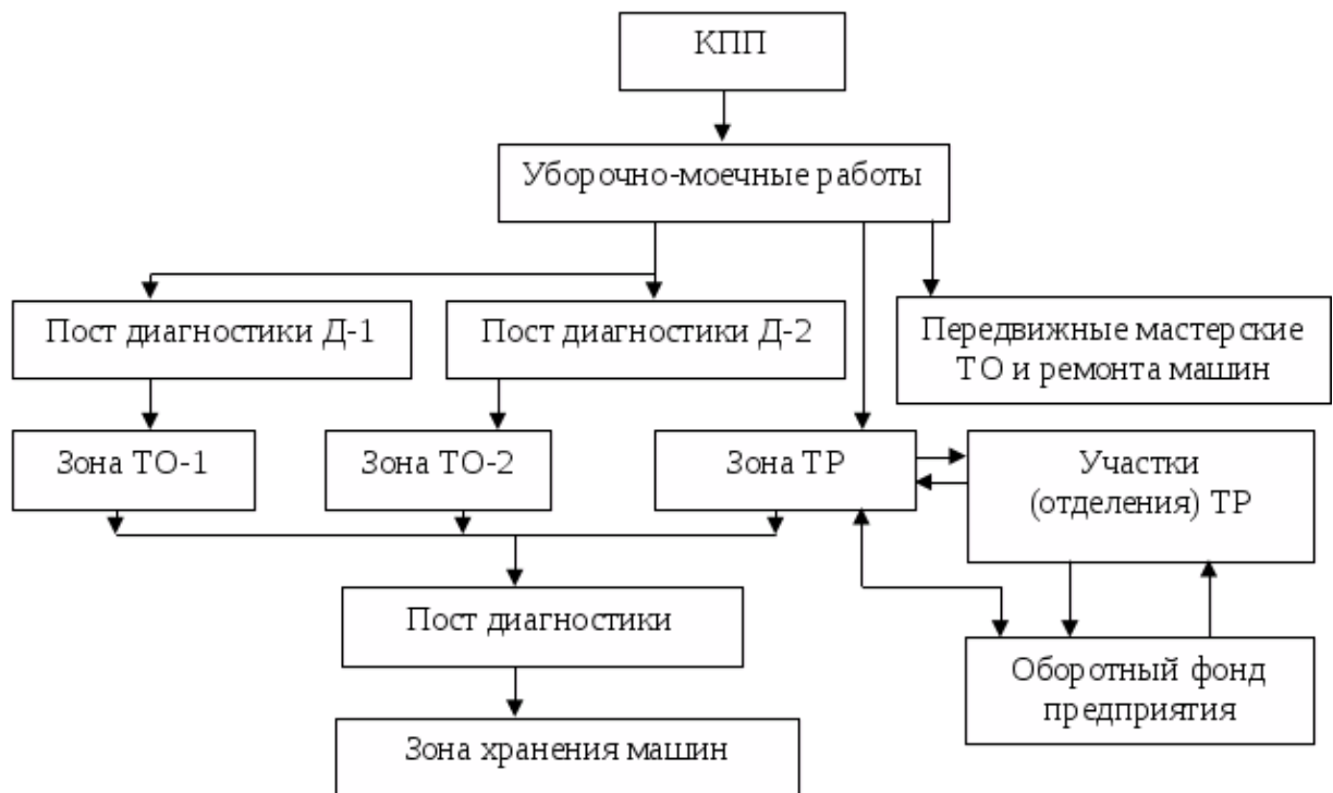
Рисунок 1.1- Общая технологическая схема ТО и ТР
