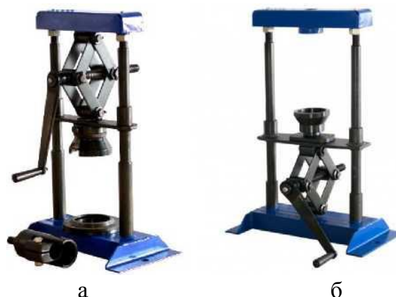
Рисунок 1.5 - Стенды С1 (а) и С2 (б) для разборки и сборки энергоаккумулятора тормозной камеры автомобиля КамАЗ
