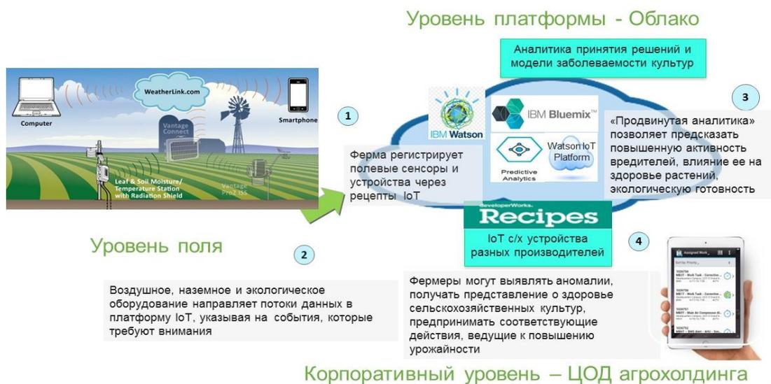
Рисунок 4 - Архитектура предсказательной аналитики в с/х на базе Watson IoT
