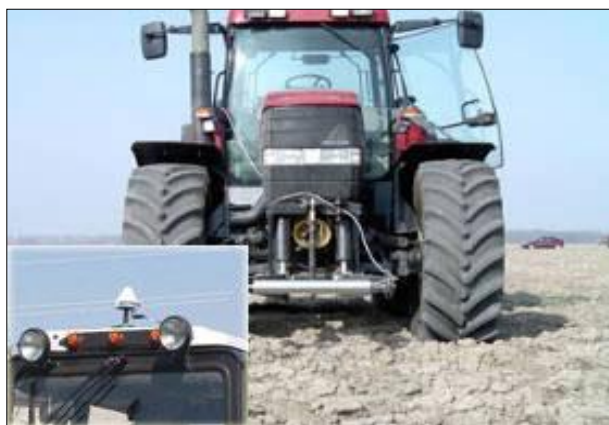
Рис. 1. Трактор, оснащенный системой параллельного вождения
